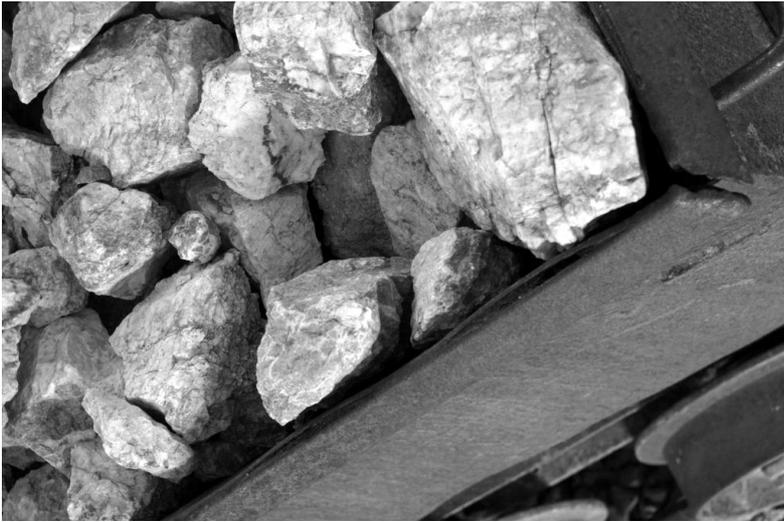
La fluorite è utilizzata principalmente nell'industria metallurgica per ottenere scorie facilmente fusibili; per la purificazione della grafite contenente silice; per la preparazione di alcuni tipi di vetri; per ottenere clinker di cemento facilmente macinabile; per la preparazione dell'acido fluoridrico da cui si estrae poi il fluoro ecc. È indispensabile nell'industria ceramica, in quella ottica, (con un titolo non inferiore al 95%) per la
