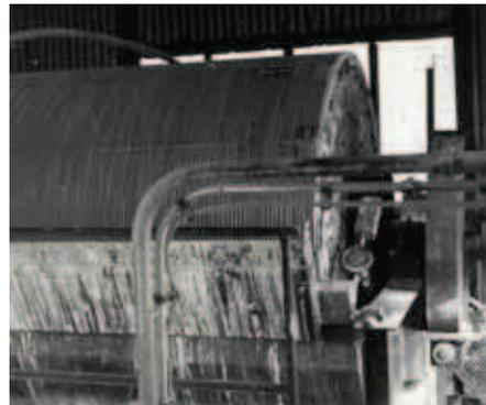
*In alto* Filtro a tamburo dell'impianto di Prestavèl. La torbida contenente il minerale separato dalla roccia sterile mediante flottazione viene addensata e filtrata per eliminare più acqua possibile.
